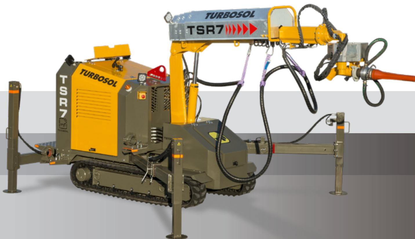
TSR 7: unité à chenilles conçue pour les applications du béton projeté sur les chantiers avec un accès difficile et dans les galeries.
